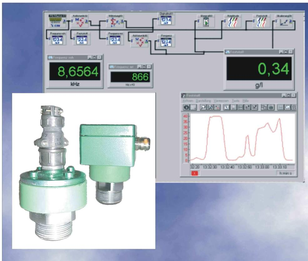
Die Skalierung der Sensorsignale erfolgt entsprechend dem Einsatzzweck des SDM2-OEM. Im einfachsten Fall kann dieses über eine Tabelle mit kundenseitig frei parametrierbaren Stützstellen erfolgen.
